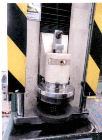
รูปที่ 4.3 รูปแสดงการวัดค่ารับภาระน้ำหนักถ่วง ( Load ) ก่อนทดสอบ
