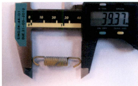
รูปที่ 4.5 รูปแสดงการวัดค่าความสูงของสปริงหลังทดสอบ
