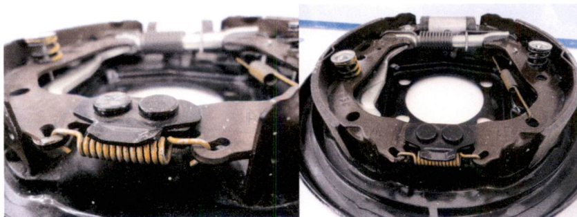
รูปที่ 4.7 รูปของสปริงดิ่งที่ทำหน้าที่ในการห้ามล้อ
