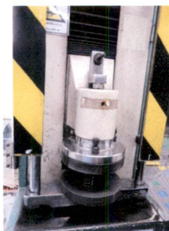
รูปที่ 4.6 รูปแสดงวัดค่ารับภาระน้ำหนักถ่วง ( Load ) หลังทดสอบ
