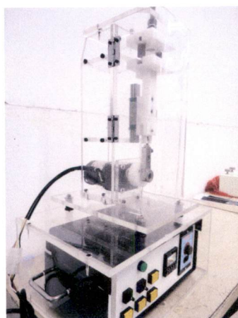
รูปที่ 4.4 รูปเครื่องทดสอบความทนทานของสปริง ที่พัฒนาขึ้น
