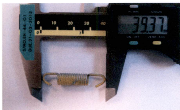
รูปที่ 4.2 รูปแสดงการวัดค่าความสูงของสปริงก่อนทดสอบ
