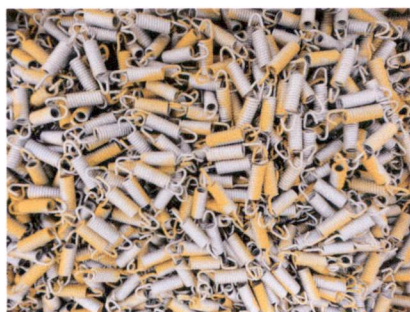
รูปที่ 4.1 รูปสปริงดึงและสปริงกด ที่ได้จากการผลิต
