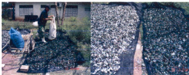
ขั้นตอน 1 ตากเปลือกหอยแมลงภู่โดยแบ่งเป็น 2 ช่วงเวลา คือ 1 สัปดาห์ และ 1 เดือน
