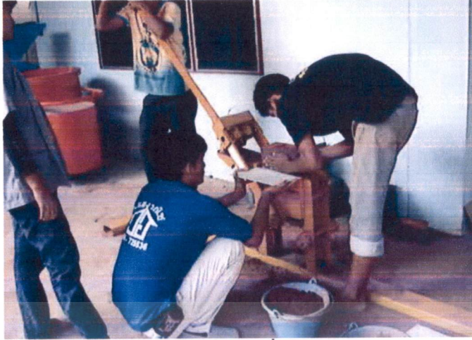
รูปที่ ก-31 แสดงการยกบดบล็อกจากเครื่องวางลงบนแผ่นสเมิร์ฟบอร์ด
