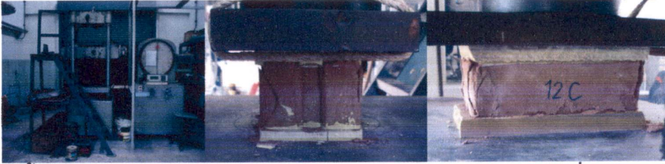
ขั้นตอน 6 การทดสอบกำลังรับแรงอัดบล็อกประสานเปลือกหอย ด้วยเครื่อง UTM สถานที่ทดสอบ อาคารปฏิบัติการวิศวกรรมโยธา คณะวิศวกรรมศาสตร์ จสจล.
