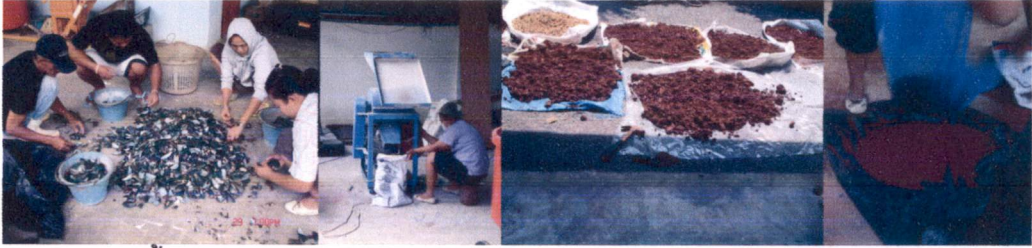
ขั้นตอน 3 การเตรียมวัตถุดิบในการผลิตบล็อกประสานเปลือกหอย บดเปลือกหอย บดร่อนดินลูกรัง
