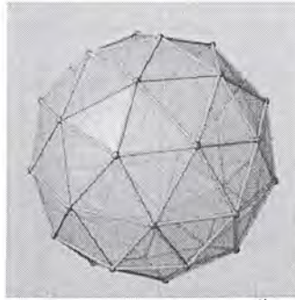
รูปที่ 2.6 แบบจำลองสามมิติแบบ mesh ประกอบขึ้นจาก vertex, edge และ face
