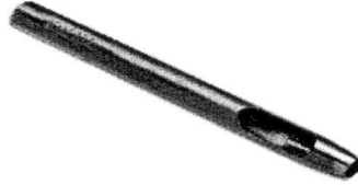
ภาพที่ 2.63 ตี๊ดตู่กลม (Round Drive Punch)
