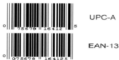
รูปที่ 2.12 เปรียบเทียบระหว่างบาร์โค้ด UPC-A และบาร์โค้ด EAN-13
