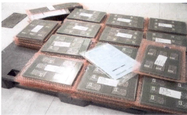
ภาพที่ 3.46 ขั้นตอนการบรรจุห้องงานด้วยความดันสูญญากาศ ที่มา : (KCEI . 2554)
