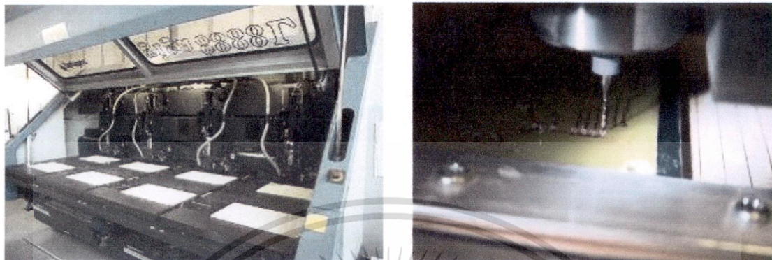
ภาพที่ 3.16 การเจาะรูบนแผ่นงาน โดยใช้เครื่องเจาะ ที่มา : (KCEI . 2554)
