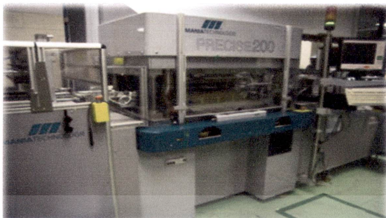
ภาพที่ 3.44 ขั้นตอนการตรวจสอบทางไฟฟ้า ที่มา : (KCEI . 2554)
