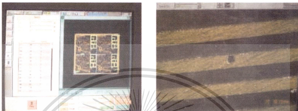
ภาพที่ 3.7 การตรวจสอบลายวงจรชั้นในตามแบบของลูกค้า
