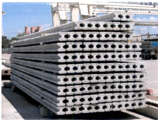
ภาพที่ 3.11 เสาเข็มคอนกรีตอัดแรงหล่อสำเร็จรูปตัวไอ ที่มา: บริษัท บันจันไทย จำกัด. 2554
