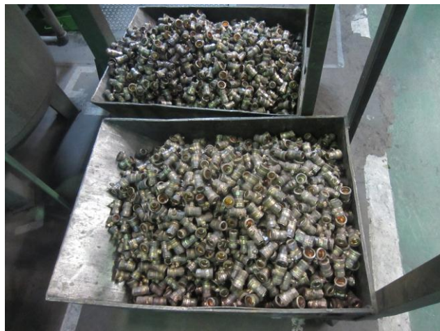
ภาพที่ 2.10 วาล์วบอลดี ที่ผ่านการปั๊มขึ้นรูปด้วยความร้อน ที่มา : KITZ Thailand Ltd. ( สิงหาคม 2556 )
