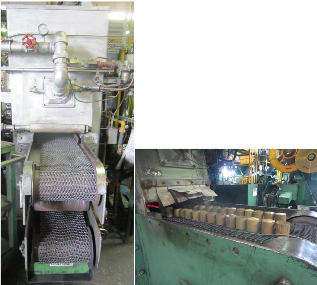
ภาพที่ 2.7 เตาเผาทองเหลืองท่อนแบบสายพาน ที่มา : KITZ Thailand Ltd. ( สิงหาคม 2556 )
