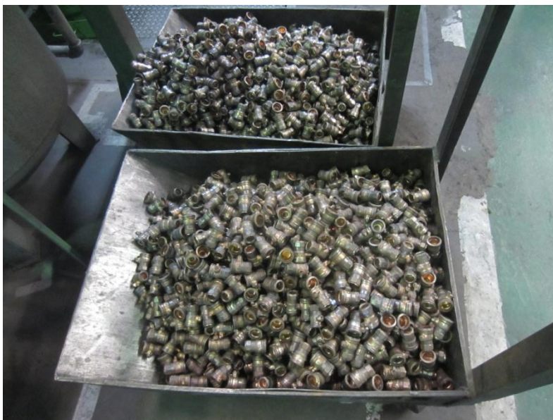
ภาพที่ 1.1 แสดงวาล์วน้ำที่ผ่านการปั๊มขึ้นรูปด้วยความร้อน ที่มา : KITZ Thailand Ltd. (2556)
