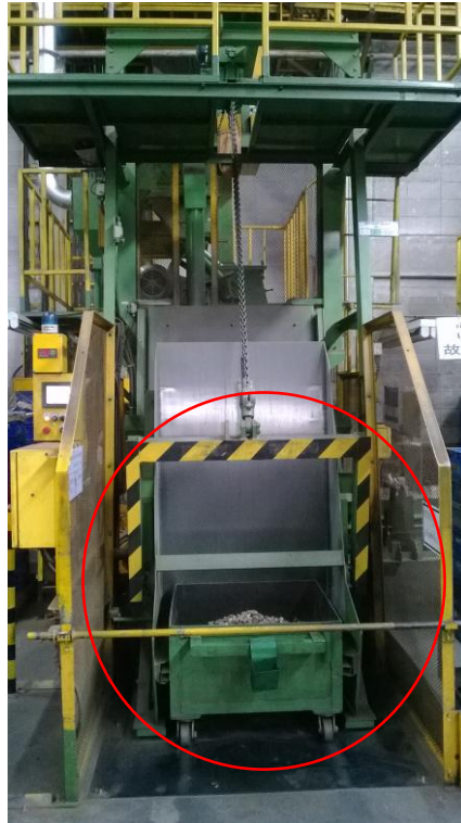
ภาพที่ 2.13 ชุดรับงานภายนอก(กระบะรับงาน) ที่มา : KITZ Thailand Ltd. ( สิงหาคม 2556 )
