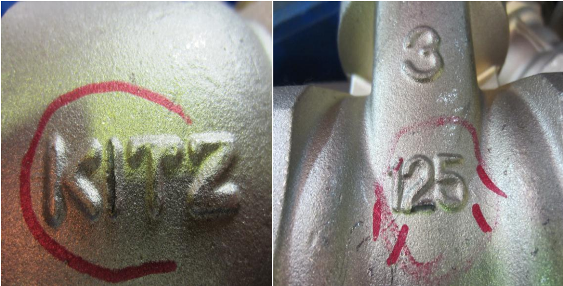
ภาพที่ 2.27 ของเสียที่เกิดจากระบวนการปั๊มขึ้นรูป ตัวหนังสือ ตัวเลข ร่อน ที่มา : KITZ Thailand Ltd. ( สิงหาคม 2556 )
