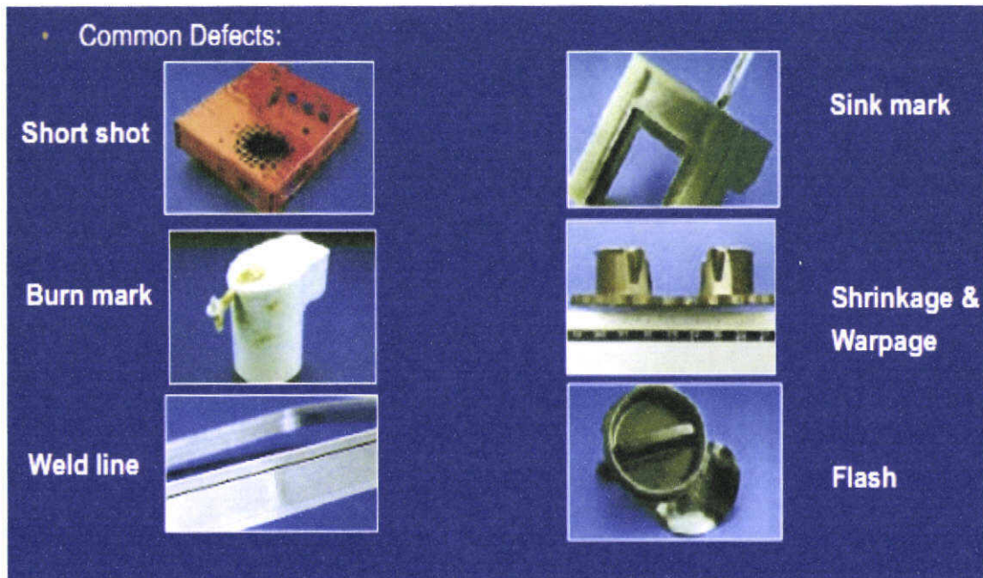
รูปที่ 1.1 ปัญหาของชิ้นงานในกระบวนการฉีดพลาสติก [1]
