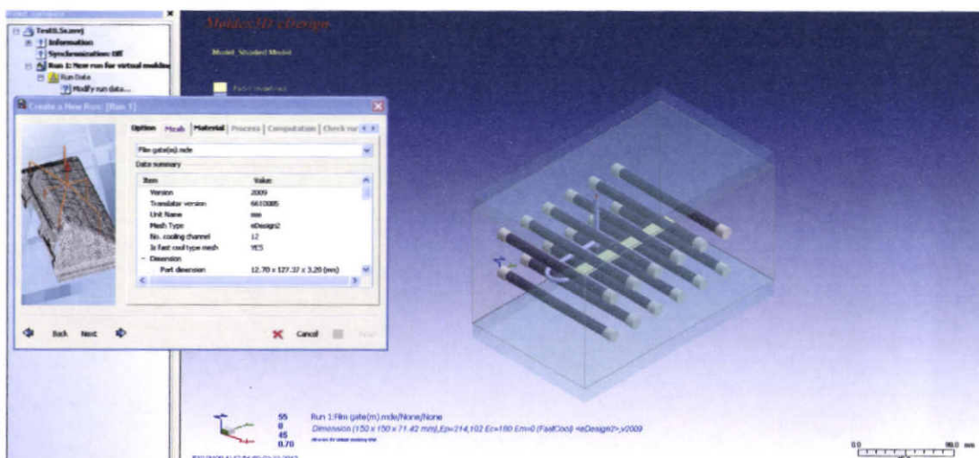
รูปที่ ค.12 Import ชิ้นงานฉีดที่ทำกรกำหนดเงื่อนไขจาก Moldex 3D designer
