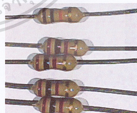
รูปที่ 4.15 จำลองการวางตัวต้านทาน S06 2k Ohm จำนวน 5 ตัวและ 10 k Ohm จำนวน 1 ตัว
