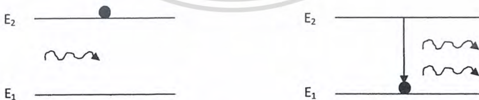
รูปที่ 2.3 กระบวนการเปล่งแสงแบบถูกกระตุ้น(John Wilson and J.F.B.Hawkes,1987)
