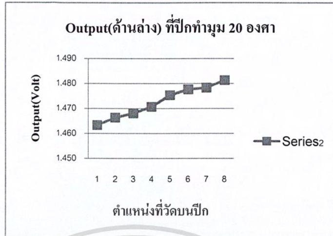
รูปที่ 4.13 กราฟความสัมพันธ์แรงดันเอาต์พุตด้านล่างปีก ที่ปีกทำมุมปะทะ 20 องศา
