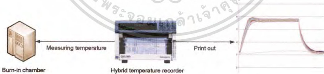
รูปที่ 3.1 แสดงกระบวนการทดสอบฮาร์ดแวร์ในสภาวะอุณหภูมิที่แตกต่าง
