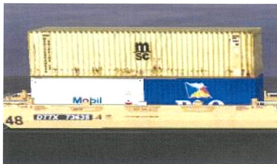
รูปที่ 2.3 การเปรียบเทียบขนาดของตู้คอนเทนเนอร์ขนาด 20 ฟุต และ 40 ฟุต [6]
