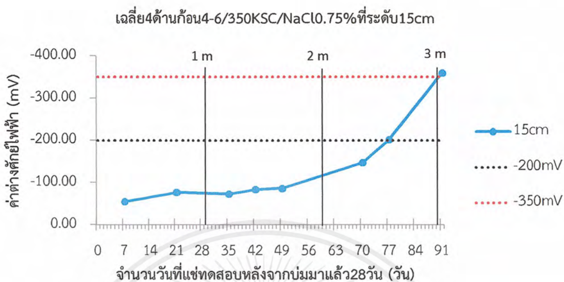
รูปที่ 4.37 เฉลี่ย4ด้านก่อน4-6ที่กำลังอัด350KSCแช่สารละลายNaCl0.75%ที่ระดับ15cm
