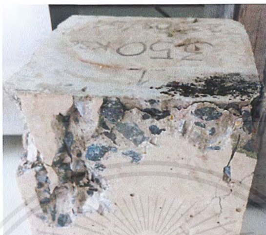
รูปที่ 3.13. การกดทดสอบคอนกรีต
