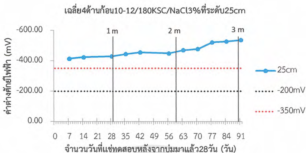
รูปที่ 4.23 เฉลี่ย4ด้านก่อน10-12ที่กำลังอัด180KSCແສสารละลายโซเดียมคลอไรด์3%ที่ระดับ
