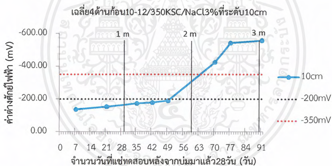
รูปที่ 4.48 เฉลี่ย4ด้านก่อน10-12กำลังอัด350KSCแช่สารละลายNaCl3%ที่ระดับ10cm
