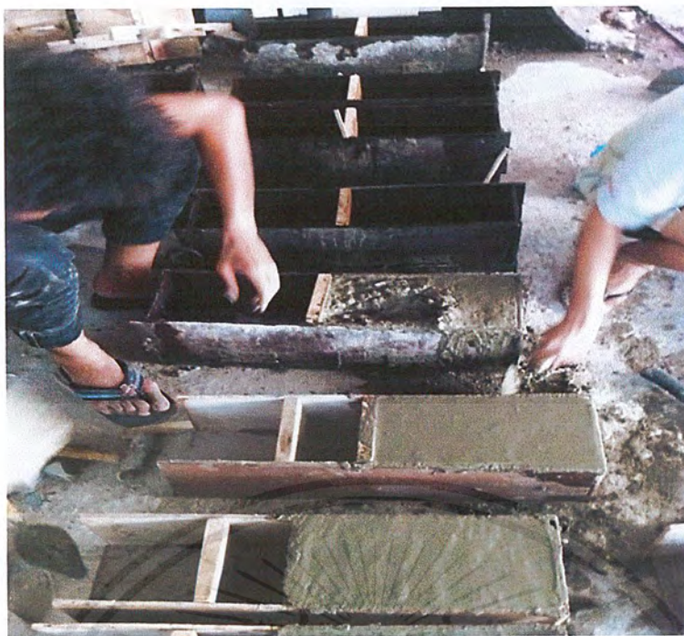
รูปที่ 3.11. การหล่อคอนกรีตตัวอย่างสำหรับทดสอบ
