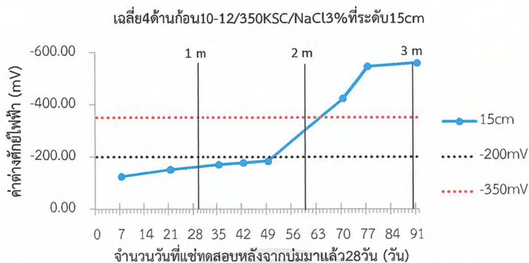
รูปที่ 4.49 เฉลี่ย4ด้านก่อน10-12ที่กำลังอัด350KSCแช่สารละลายNaCl3%ที่ระดับ15cm
