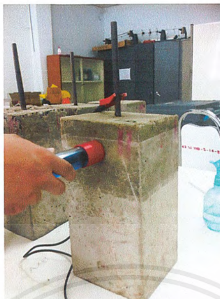
รูปที่ 3.28. การทดสอบHalf cell
