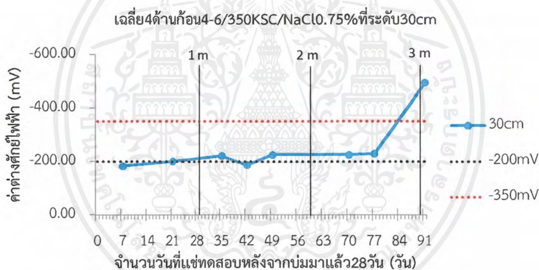
รูปที่ 4.40 เฉลี่ย 4 ด้าน ก่อน 4-6 ที่กำลังอัด 350KSC แข่งสารละลาย NaCl 0.75% ที่ระดับ 30cm
