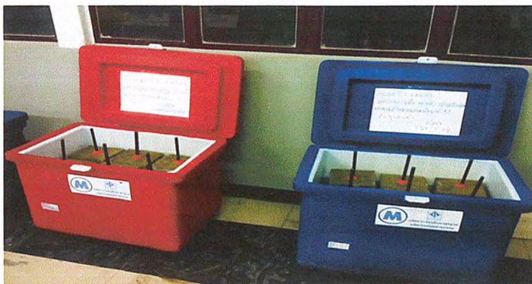
รูปที่ 3.21. การแช่คอนกรีตในสารละลายโซเดียมคลอไรด์
