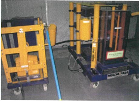
เครื่องกำเนิดแรงดันอิมพัลส์ Impulse Generator 200kV,5kJ
