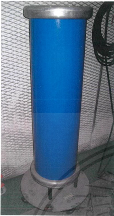
โวลเตจดีไวเดอร์อ้างอิง ที่ใช้ในระบบวัดแรงดันกระแสสลับ - Nameplate unspecified
