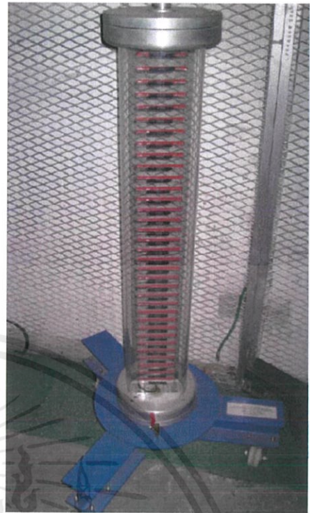
โวลเตจดีไวเดอร์อ้างอิง ที่ใช้ในระบบวัดแรงดันกระแสตรง - R-C Voltage divider - Rated Voltage AC/DC 50kV - Rated Ratio AC/DC 1000/1 - Rated Capacitance(Hi) 104.7 pF - Rated Capacitance(Low) 104.7 nF - Rated Resistance(Hi) 350M \Omega - Rated Resistance(Low) 350 \Omega - Frequency 50Hz Filling O 2
