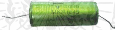
รูปที่ 3.2 ตัวเก็บประจุภาคแรงสูงสำหรับวัตต์แรงดันกระแสสลับ
