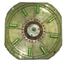
รูปที่ 3 ชุดอิมพีแดนซ์ภาคแรงต่ำเมื่อประกอบเสร็จ
