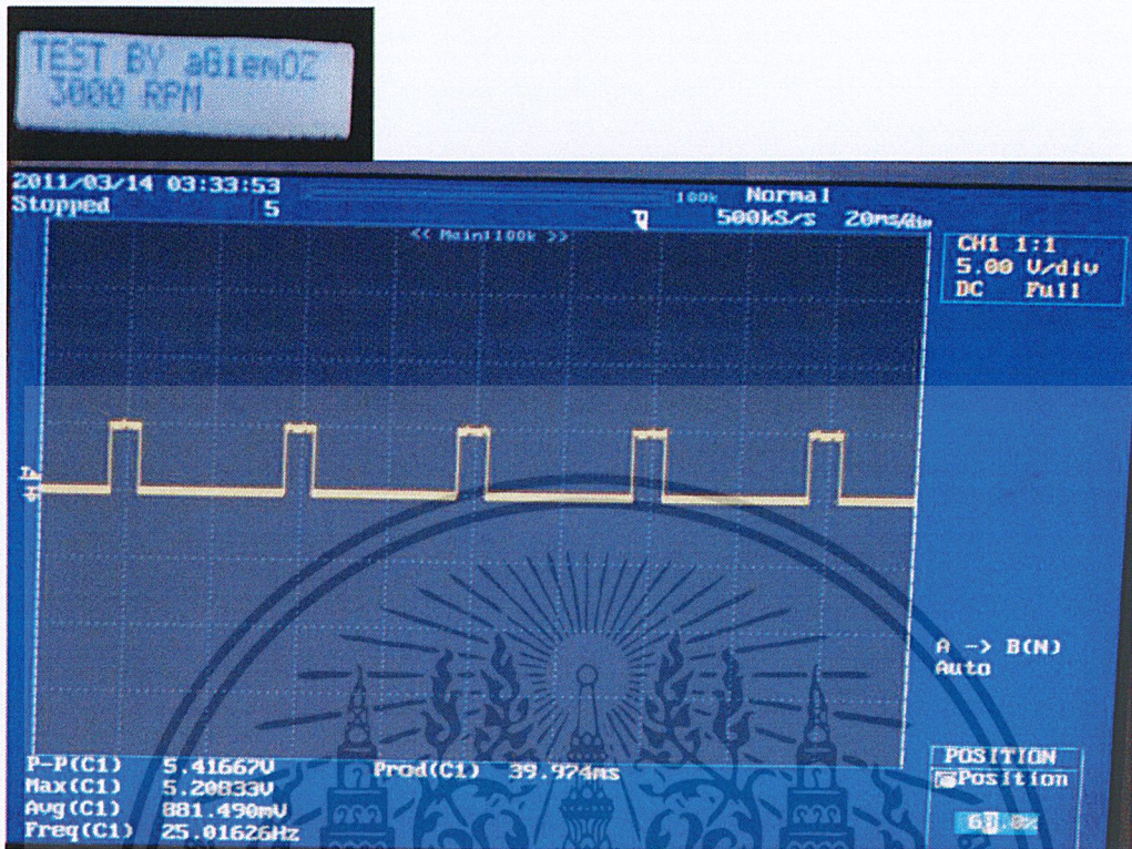
รูปที่ 5.4 แสดงผลสัญญาณพัลส์ที่ความเร็วรอบ 3000 rpm ความถี่ 25 Hz
