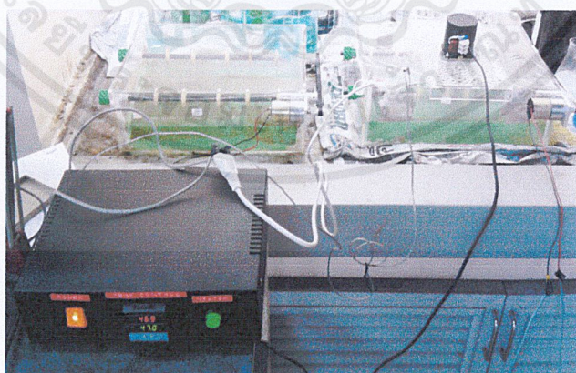
รูปที่ 3.2 ชุดจำลองอุปกรณ์และถังบรรจุสารละลาย Entek
