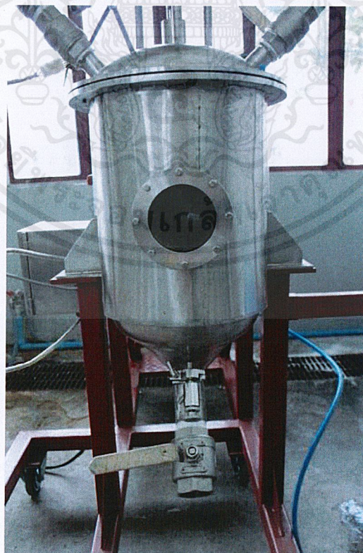
รูปที่ ค.8 แสดงภาพถ่ายของถังสกัดและตกตะกอน
