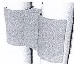
ภาพที่ 1.24 แสดงชิ้นส่วนที่ช่วยในการยึดระหว่างเสากับขาเตียงเพื่อป้องกันการลื่นไถล
