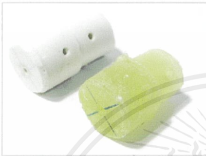
แสดงรูปแบบข้อต่อแบบจุกยางที่กำจากวัสดุที่มีความยืดหยุ่นต่างกัน
