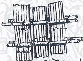
⑦ ฝา ลวดตาไม้ไผ่ลวด \phi 3 " ขลุ่ย ลวดตาไม้ไผ่ลวดเล็ก \phi 2 " ขลุ่ย
