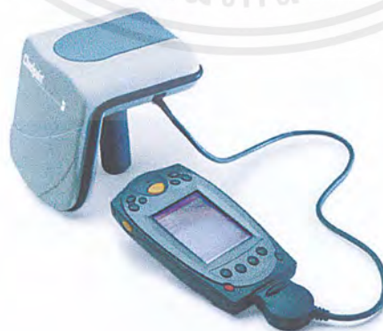
ภาพที่ 6.28 ชุดอุปกรณ์เก็บข้อมูลเคลื่อนที่
