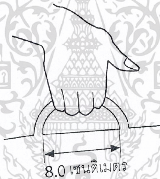
ภาพที่ 2.45: แสดงลักษณะการใช้งานมือจับ
