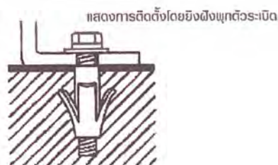
ภาพที่ 2-74 แสดงการติดตั้งโดยยิงฝังทุกตัวระเบิด
