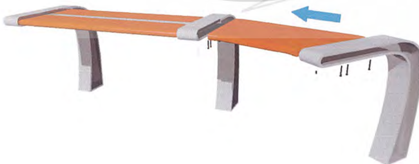
ภาพที่ 4-9 ภาพแสดงรายละเอียดลักษณะการประกอบติดตั้งม้านั่ง ส่วน Join (ต่อ)
