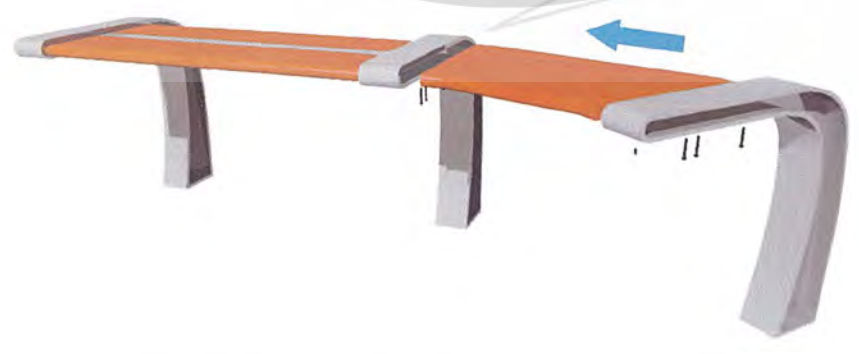
ภาพที่ 4-7 ภาพแสดงรายละเอียดลักษณะการประกอบติดตั้งที่นั่ง ส่วน Join (ต่อ)
