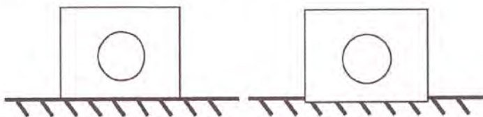
ภาพที่ 2-72 แสดงการติดตั้งแบบลอยตัว
