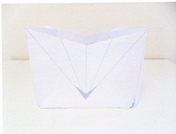
รูปที่ 3.19 Model study โครงสร้างปีกค้ำคาบบริเวณรอยพับ แบบที่ 1
