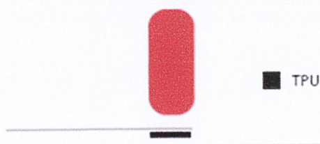
รูปที่ 2.21 แสดงลักษณะการเชื่อมตะเจ็บบีบแบบบัดเวลด์ขั้นตอนที่ 2
