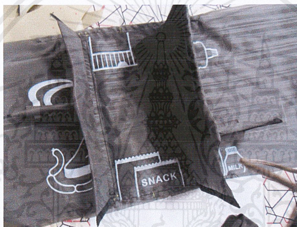
รูปที่ 3.39 ช่องกั้นผลิตด้วยวิธีการติดเวลโคร (Velcro)
