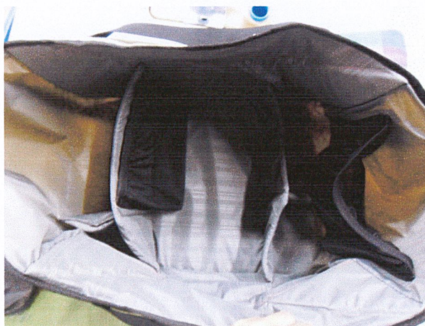
รูปที่ 3.38 ช่องกั้นผลิตด้วยวิธีการเย็บ
