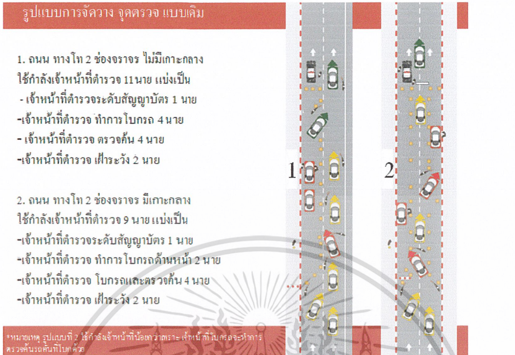
ภาพที่ 4.4 แสดงรูปแบบการจัดวางของจุดตรวจเดิม 2 ช่องจราจร แบบมีเกาะกลางและไม่มีเกาะกลาง
