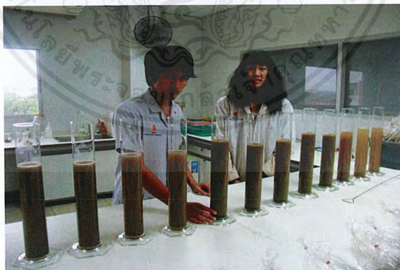
ภาพที่ 3 การหาขนาดอนุภาคดินโดยวิธีการตกจมของอนุภาคในของเหลว
