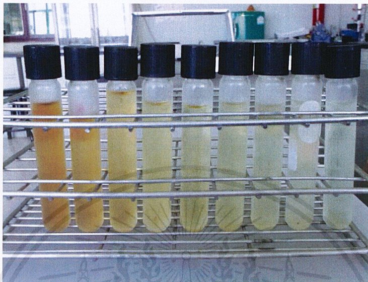
รูปที่ 4.5 แสดงสีของน้ำเสียที่ผ่าน โอโซนที่ ทุกๆ 30 นาทีของการทดลอง
