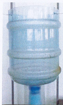
รูปที่ ค.3 ถังตกตะกอน
