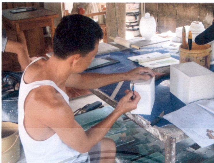
ภาพที่ ข 1 แสดงช่างปั้นผู้ชำนาญในการสร้างต้นแบบและแม่พิมพ์ (คุณ สมจิตร แปงแก้ว) กำลัง สร้างต้นแบบและแม่พิมพ์ตามแบบที่ผ่านการคัดเลือกจากผู้เชี่ยวชาญ
