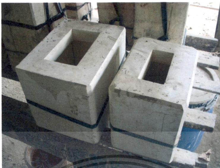
ภาพที่ ข 5 แสดงแม่พิมพ์สำหรับหล่อผลิตภัณฑ์ที่ใช้ในการวิจัย (ขณะประกอบแม่พิมพ์)
