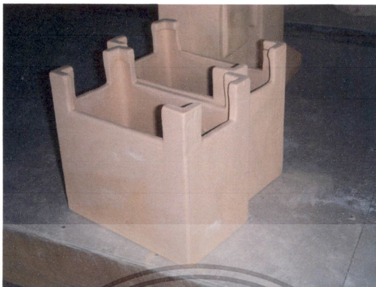
ภาพที่ ข 9 แสดงผลิตภัณฑ์ที่ผ่านการเผาที่อุณหภูมิ 850 องศาเซลเซียส
