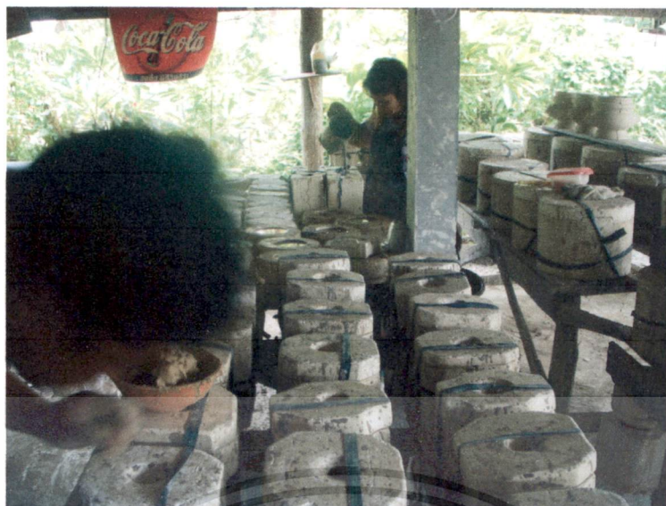
ภาพที่ ข 7 แสดงการหล่อน้ำคินลงแม่พิมพ์ปูนพลาสติกอร์
