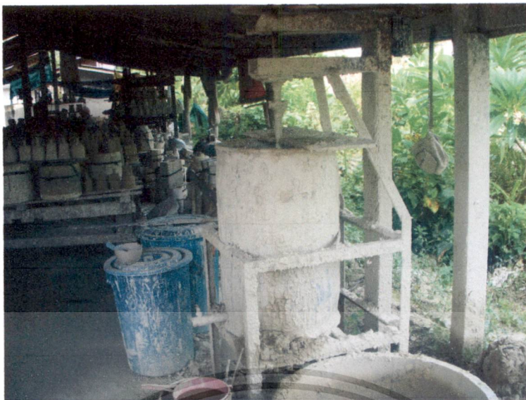
ภาพที่ ข 3 แสดงถังสำหรับบดผสมน้ำคั้น (วัดถุดิบ)
