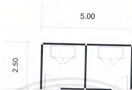
รูปที่ 4.1.55 แสดงขนาดพื้นที่ของส่วนเปลี่ยนชุด
