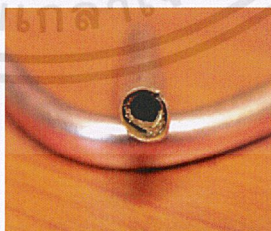
รูปที่ 2.12 Metal mesh wicks [9]
