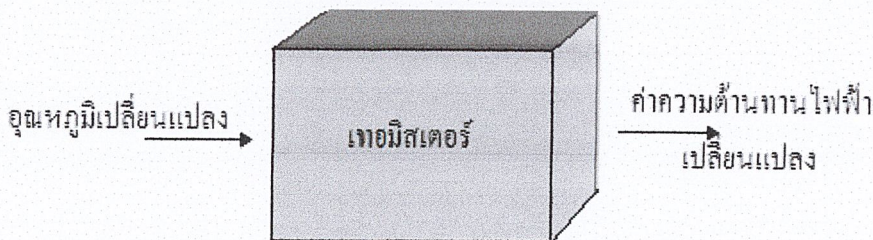
รูปที่ 3.1 หลักการทำงานพื้นฐานของเซนเซอร์แบบต่างๆ
