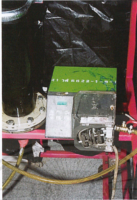
รูปที่ ค.4 ปุ่มที่ทำให้ตะกอนจุลินทรีย์ภายในคอลัมน์เกิดการหมุนวน
