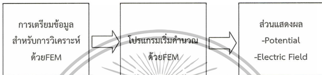
รูปที่ 3.3 ลำดับการทำงานของโปรแกรมคำนวณและวิเคราะห์ด้วยวิธีไฟไนต์เอลิเมนต์
