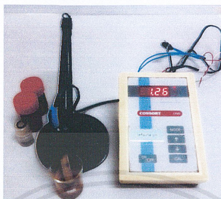
รูปที่ 4.1 การทดลองวัดค่าความเป็นกรด - ด่าง
