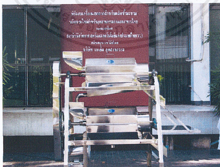
รูปที่ 2.6 เครื่องแยกกากสำหรับผลิตน้ำมะขามเปียก
