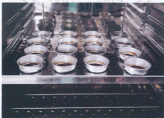
รูปที่ 4.6 การทดลองวัดปริมาณของแข็ง ขั้นตอนการนำตัวอย่างมาอบที่ตู้อบ
