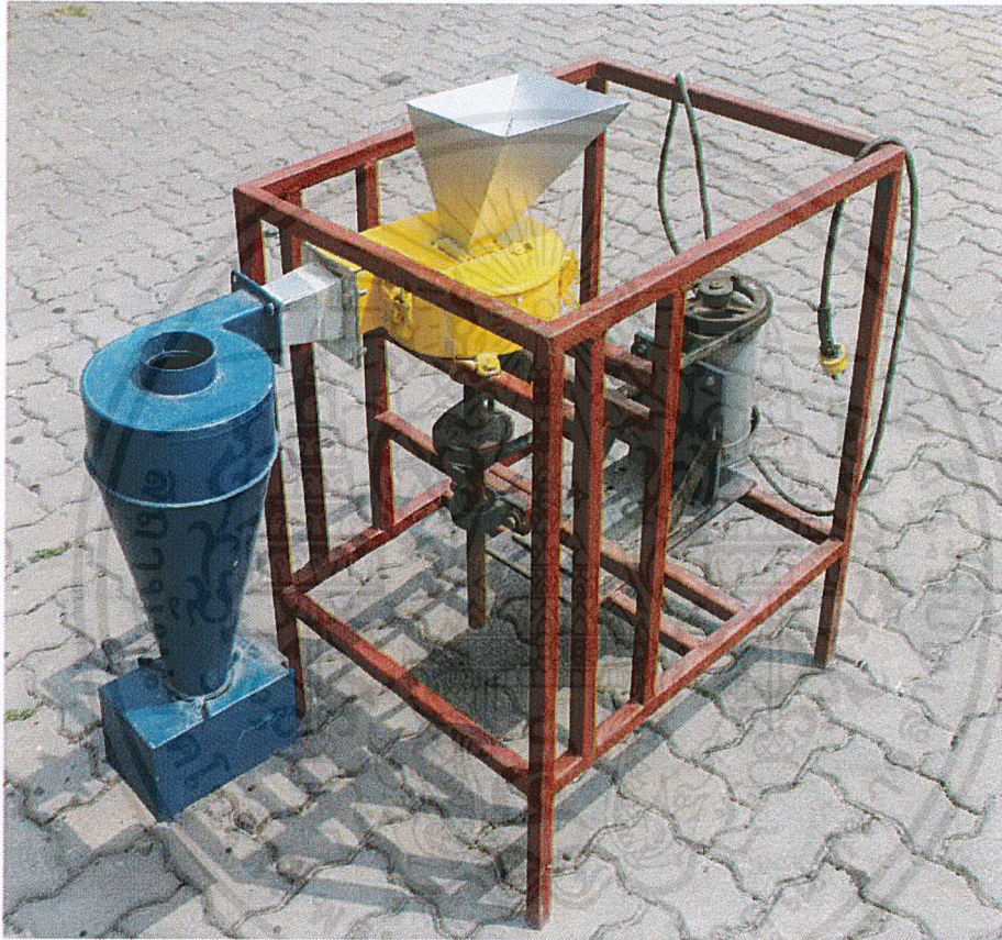
รูปที่ 3.4 ชุดทดสอบที่ใช้ในการกะเทาะเปลือกเมล็ดมะรุมแบบใช้แรงเหวี่ยงหนีศูนย์กลาง 2
