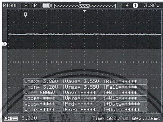
รูปที่ 4.16 สัญญาณที่ได้จากวงจรตรวจวัดความเข้มแสง
