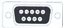
รูปที่ 2.30 DB9 ตัวผู้ เมื่อมองจากด้านหลัง
