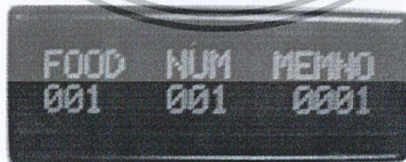
รูปที่ 4.12 หน้าจอ LCD เมื่อทำการกดรหัสอาหาร
