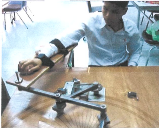
รูปที่ 4.7 การทดลองการเคลื่อนที่แบบเลขแปดโดยแพทย์ผู้เชี่ยวชาญ
