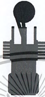
รูปที่ 2.9 ขั้นตอนที่ 1 ของการทำงานในเครื่องยนต์สเตอร์ลิงชนิดเบตา
