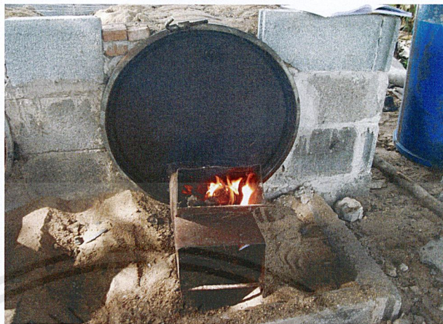
ภาคผนวกภาพ ภาพที่ 12 จุดไฟหน้าเตาเพื่อไล่ความชื้นของไม้ฟืนและมั่งคุดเพื่อผลิตถ่านมั่งคุด
