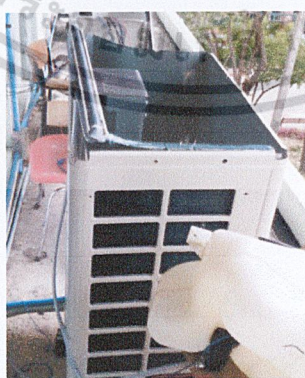
รูปที่ 4.13 ชุดจำลองหยดน้ำแบบต่อร่วมกับท่อเปล่า
