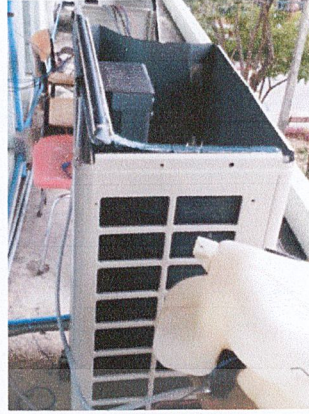
รูปที่ 3.3 ชุดจำลองหยดน้ำแบบปั๊มและท่อรางผ้า
