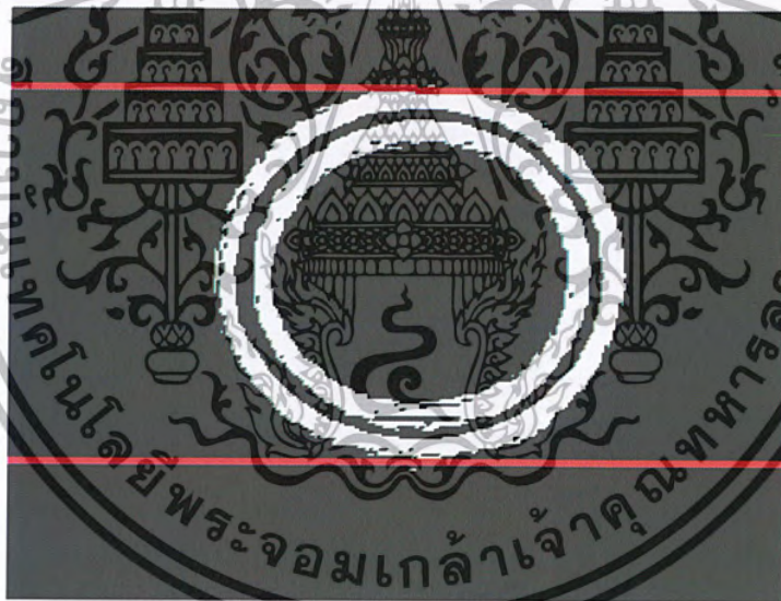
รูปที่ 3.31 การหาพิกัดขอบบนและขอบล่างของวัตถุ
