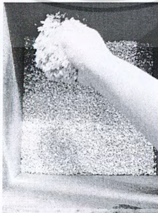
รูปที่ 3.7 การ โรยชั้นกล่องเครื่องดัด U.H.T. ในกล่องเตรียมแผ่นอัด
