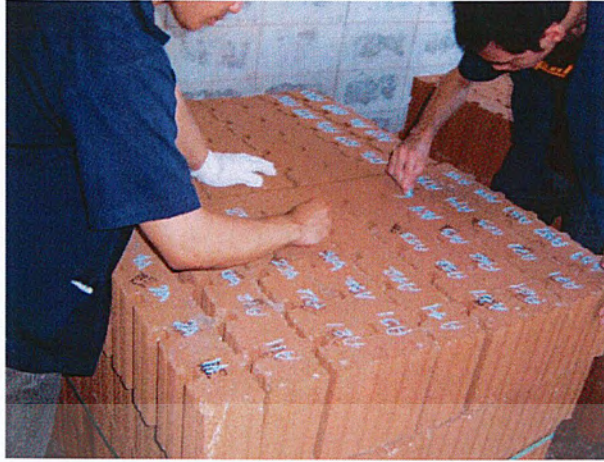
รูปที่ 3.20 ภาพแสดงการเก็บข้อมูลโดยการระบุเลขรหัสลงบนก้อนอิฐแต่ละก้อน
