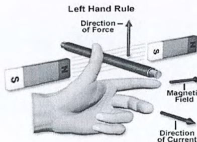
รูปที่ 2.6 หลักการทำงานของ DC Motor
