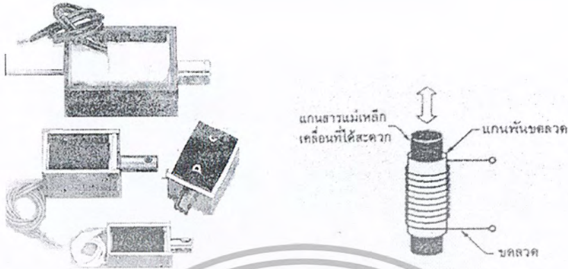
รูปที่ 2.38 โซลินอยด์รูปแบบต่างๆ และโครงสร้างพื้นฐานของโซลินอยด์
