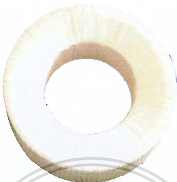
รูปที่ 3.7 แกนหม้อแปลงพันผ้าพันหม้อแปลง
