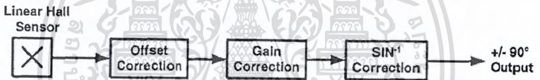
รูปที่ 10 สัญญาณที่เข้าสู่เซนเซอร์วัดตำแหน่งเชิงมุม
